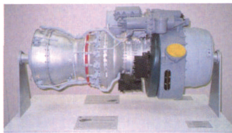
图4 用SLA技术制作的全尺寸航空发动机模型
