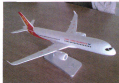
图5 利用SLA技术制作的C919模型
